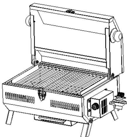
Vissez le régulateur sur le côté du boîtier de commande. Ne serrez pas trop fort.
